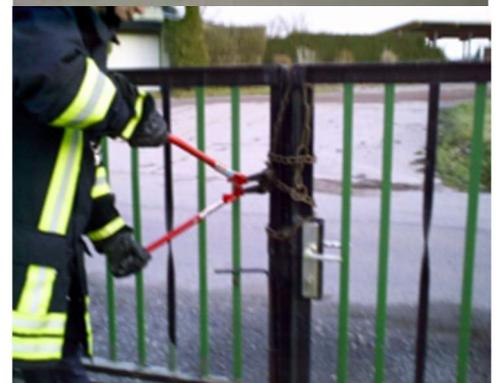
Abbildung 5: Bolzenschneider und Anwendung
