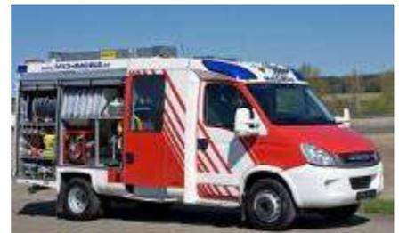
Abbildung 9: Staffellöschfahrzeug (Iveco-Magirus)
